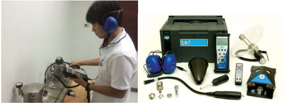
ภาพที่ 5 Ultrasonic Air leak detector
